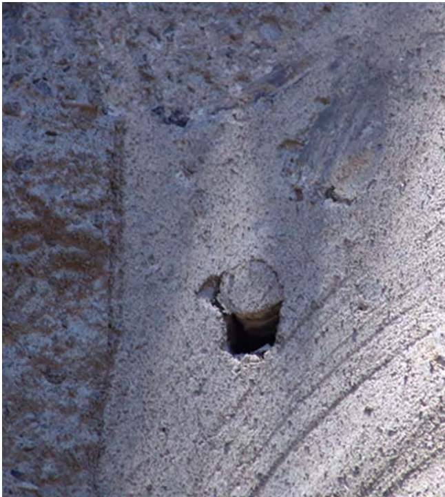
Fig. 4: El vacío debajo del refuerzo en el espécimen cortado con sierra se produjo a partir del movimiento hacia abajo.
